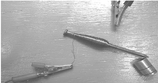
Yon elektwoleman se yon bobin sou yon bout fè. Lè li gen kouran sou li, li rale fè. Lè li pa gen kouran sou li, li pa leman ankò.
