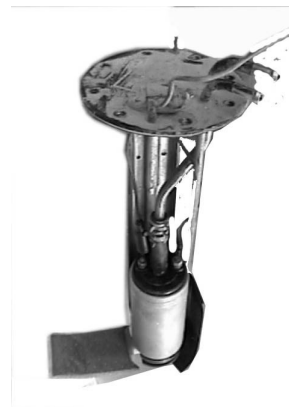
Ponp gaz elektrik.
